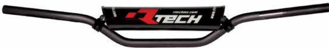
Handlebar replica bend KTM SX 85 mini Ø22 mm (7/8") Manubrio replica piega ktm sx 85 mini Ø 22 con paracolpi R-MNSXJNR0022 - black color
